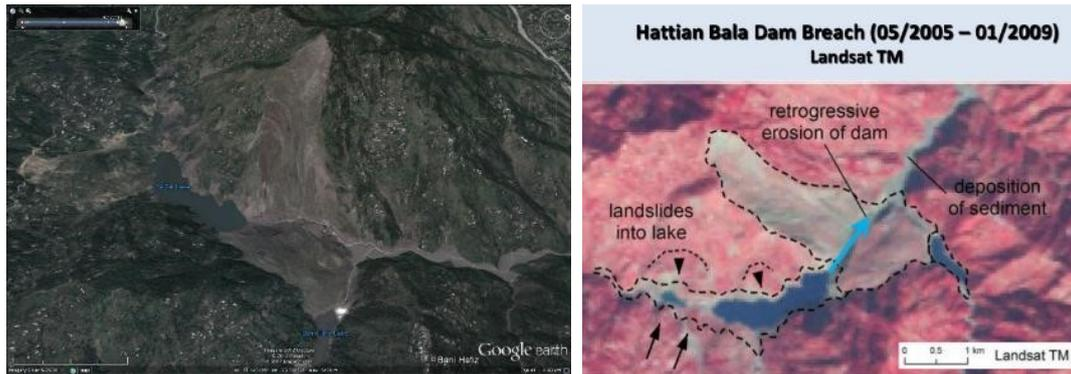
Abbildung 3: Hattian Rutschung, Kashmir, Pakistan, 8. Oktober 2005. Etwa 68 Mio m<sup>3</sup>. Rückschreitende Erosion auf der talabwärts gerichteten Seite des Damms.
