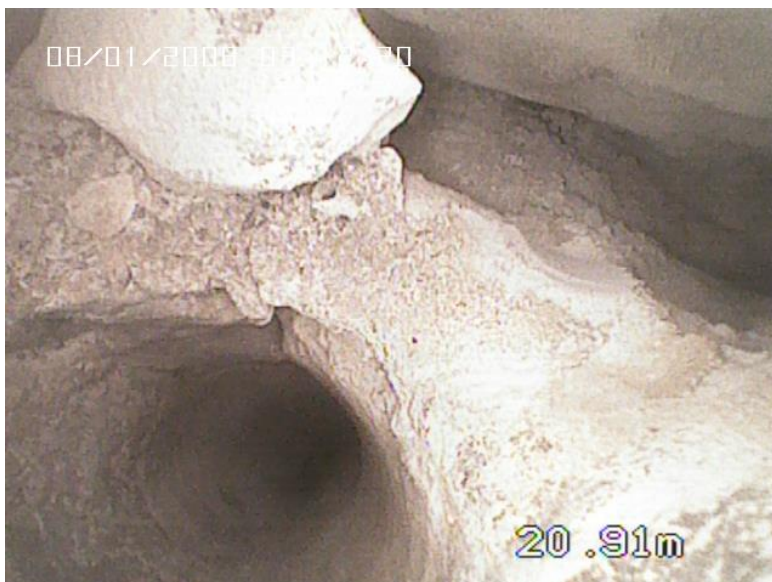
Abbildung 4: Vertikale Kluft im ansonsten kompakten Kalkstein. Der lose Gesteinskörper hat Steingröße (zum Vergleich: das Bohrloch hat einen Durchmesser von 90 mm).
