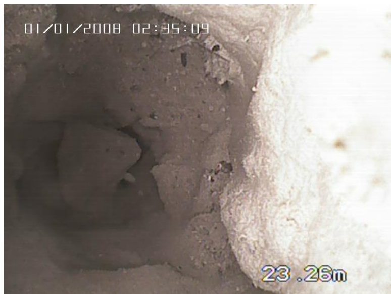
Abbildung 8: Mit Bohrmaterial verfüllte vertikale Kluft. Ein herausgefallener Stein blockiert das Bohrloch, was eine Nachbohrung nötig machte.
