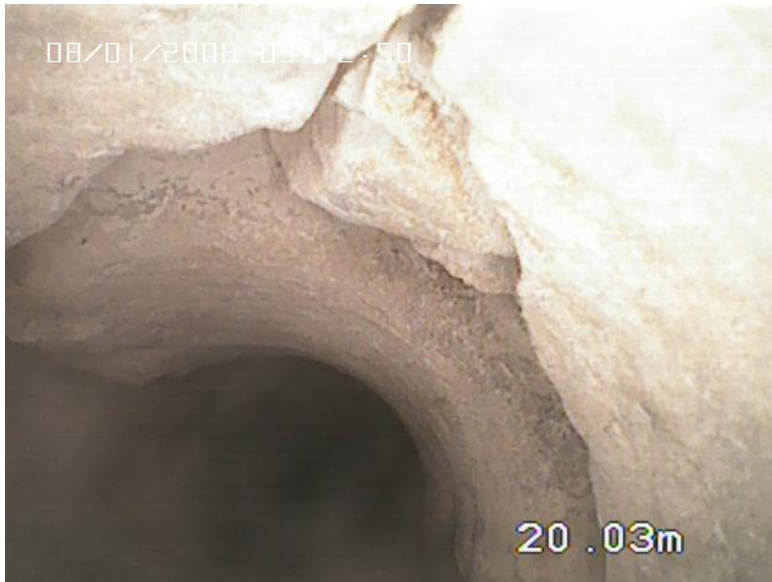
Abbildung 3: Kompakter Kalkfels mit horizontaler und vertikaler Klüftung.
