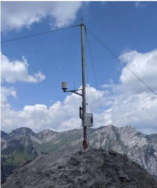
Zur Ergänzung des Überwachungssystems wurde am Westgrat (wo früher die hochauflösende Kamera stand) ein Regenmesser installiert. Damit wird gemessen wie viel Niederschlag in einer bestimmten Zeit pro Vergleichsfläche fällt. Das Gerät wurde in die Datenplattform von Geopraevent eingebunden und liefert nun verlässliche Werte; Ziel ist es noch besser zu erkennen, welche Auswirkungen anhaltende Niederschläge bzw. Starkgewitter auf die Bewegungen im Überwachungsgebiet haben.
